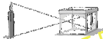
Camera obscura: Durch ein Loch in einer dunklen Kammer wird ein Abbild erzeugt
