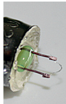
Glühlampe mit zerstörtem Glaskolben
